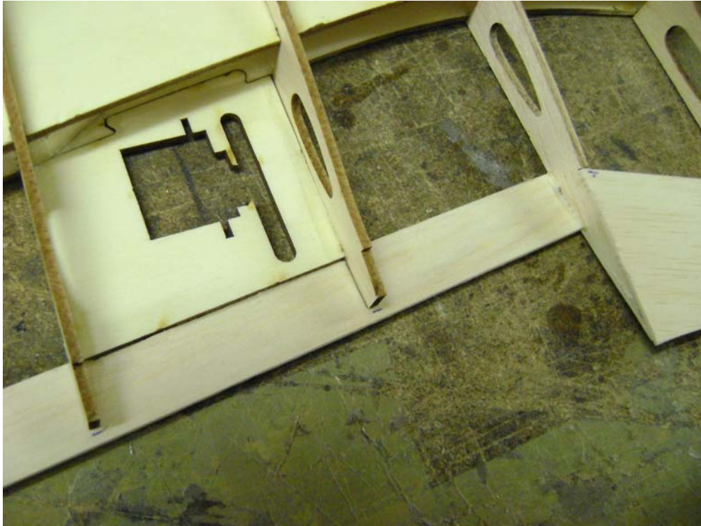
Die Endleiste entsteht aus 2mm Balsa. Hier der Bereich der Ruderklappen.
