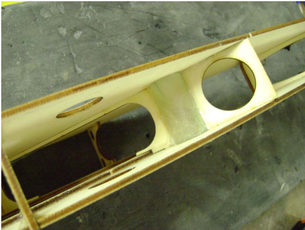
Ein Stück Steckungsrohr kann schon eingearzt werden.
