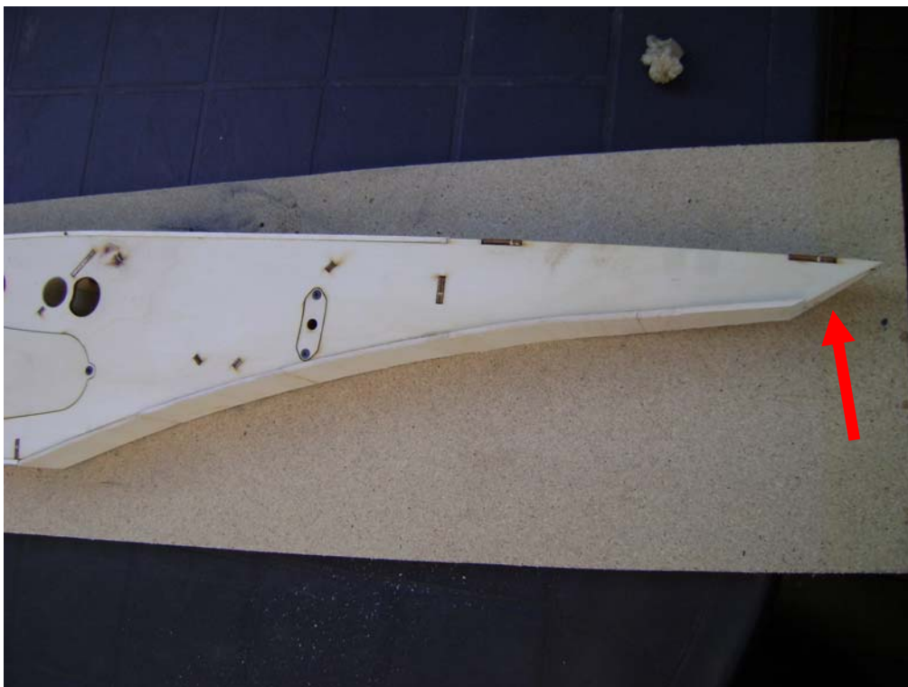
Den rsp 15 , das ist der Aufnahmeckel des Seitenruders, aufleimen. Dabei muss der Rumpf nur wenig zusammengezogen werden. Dann können wir gleich das hintere Rumpfunterteil mit Balsa beplanken. Hier kann die Maserung quer sein. Bitte die Schräge hinten am Rumpf offen lassen (Pfeil)
